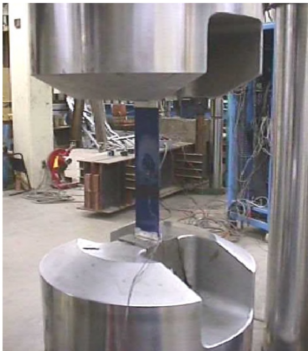
Esecuzione del test secondo ASTM D3039
